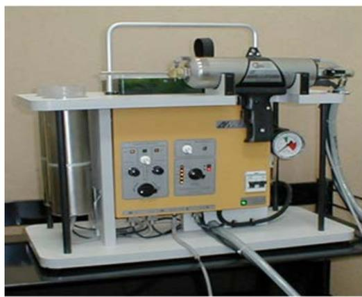
Рисунок 2 – Оборудование ДИМЕТ-403К для нанесения газодинамических покрытий
