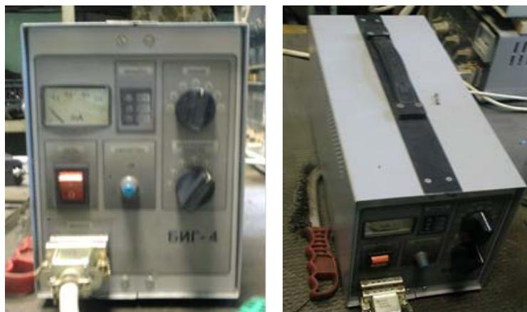
Рисунок 1 – Установка для электроискровой обработки БИГ-4
